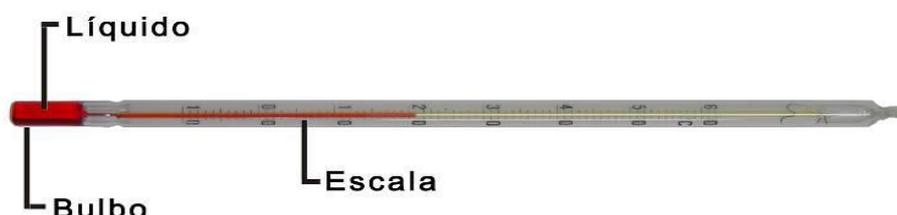
**Figura 7 – Termômetro de álcool com capilar evacuado.**
