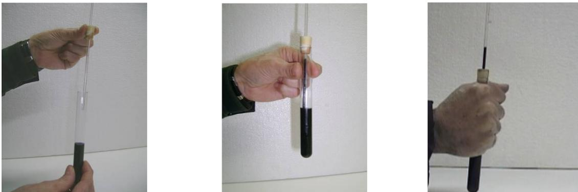
*A sequência de imagens mostra a variação da temperatura de um termoscópio de álcool.*
