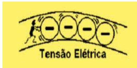
O mesmo ocorre com as cargas, ou especificamente o elétron, que ao submetido a uma diferença de potencial elétrica, ganham energia cinética, e se movimentam a uma determinada direção.
