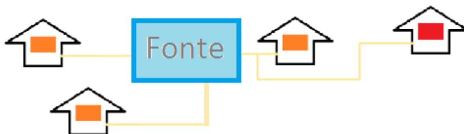
A casa que estava cinza (apagada) se conectou a fonte de certa forma que também recebe energia elétrica. E é este o princípio de um **'gato' elétrico**. Sob uma perspectiva técnica, nada mais é do que uma ligação em paralelo com outro resistor.
