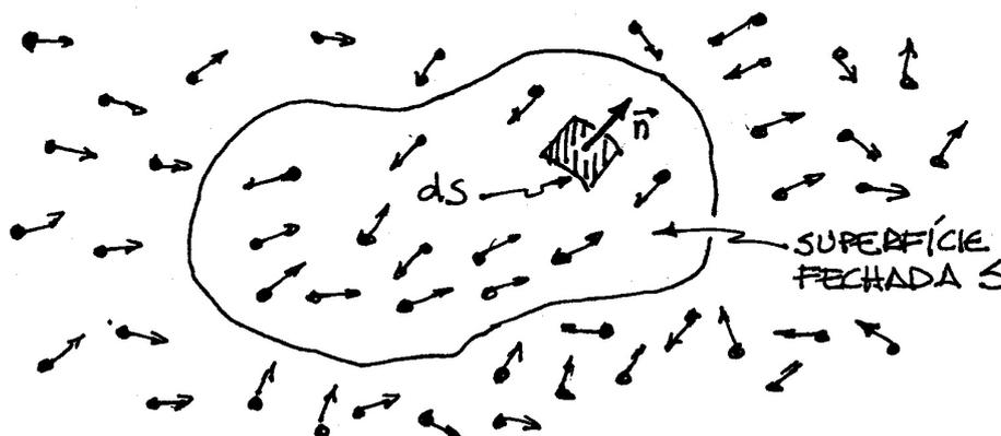
Figura 26.3: Os pontos escuros representam cargas elétricas e as flechas, as direções de suas velocidades. À medida que o tempo passa, algumas dessas cargas entram na superfície matemática  $S$ , outras saem dela, ocasionando uma variação da carga total contida no seu interior.
