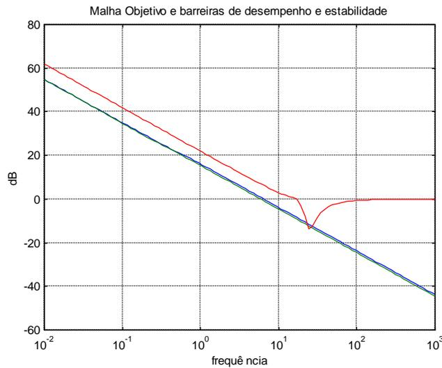
É necessário verificar se  $G_{KF}$  em malha fechada satisfaz a condição de robustez da estabilidade. A figura abaixo mostra os valores singulares de  $G_{KF}$  em malha fechada e a barreira da estabilidade. Pode-se verificar que a condição é satisfeita.
