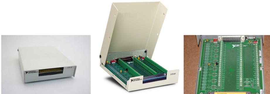
Figura 7: Bloco de conectores SCB-68.
