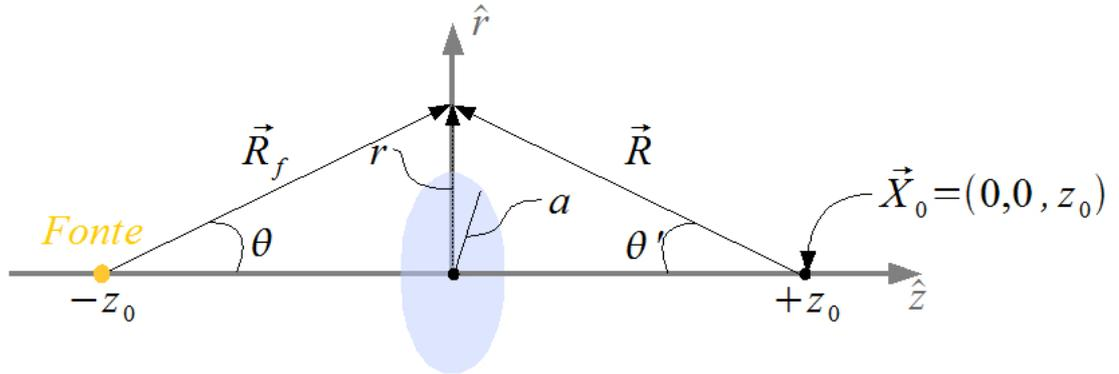
Como indicado na figura acima, uma fonte pontual está posicionada no ponto  $-z_0$  do eixo de um disco de raio  $a$ . Em oposição, no ponto  $z_0$ , está nosso ponto de observação. Utilizando o princípio de Balbinet, a integral de Fresnel-Kirchhoff no ponto de interesse é:
