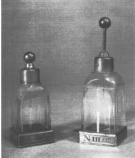
Eletroscópios de folhas de ouro de Bennet.
