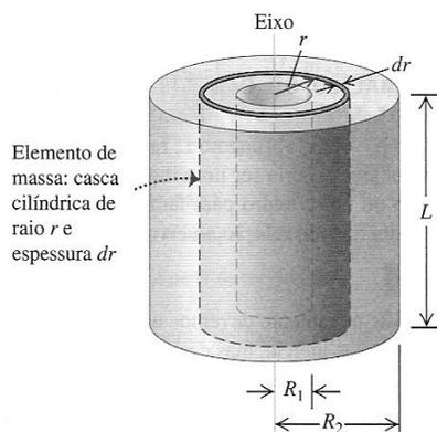
**Figura 9.24** Determinação do momento de inércia de um cilindro oco em relação ao seu eixo de simetria.
