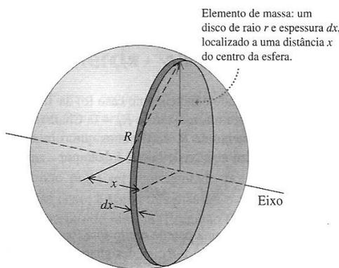
**Figura 9.25** Determinação do momento de inércia de uma esfera em relação a um eixo que passa através do seu centro.
