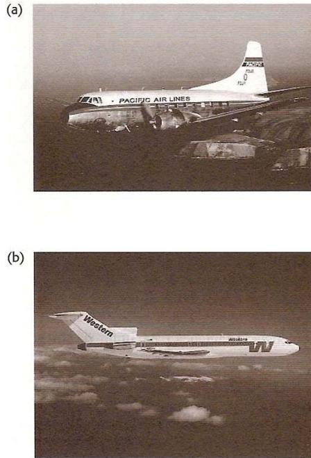
Figura 6.27 (a) Um avião movido a hélice e (b) Um avião a jato moderno.
