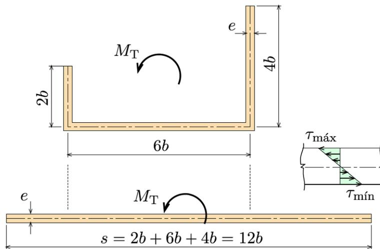
Fig. 12: Retificação da seção delgada aberta com espessura constante.
