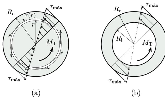
Fig. 2: Distribuição das tensões nas seções (a) circular e (b) anelar.
