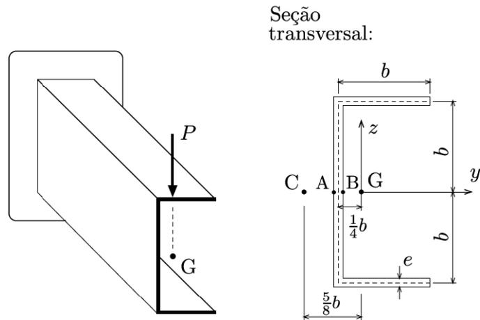
Fig. E 3: Viga sujeita à flexo-torção.
