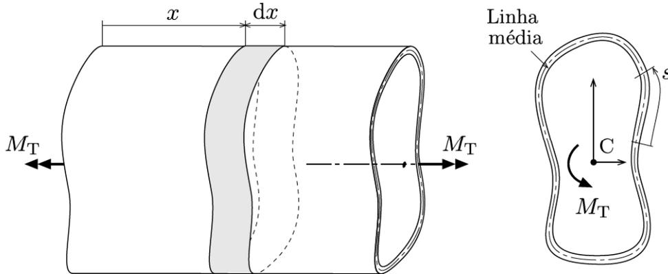
Fig. 14: Barra de seção unicelular.
