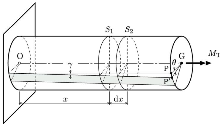
Fig. 1: Torção de uma barra circular.
