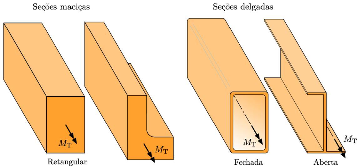
Fig. 3: Torção de seções não-circulares.
