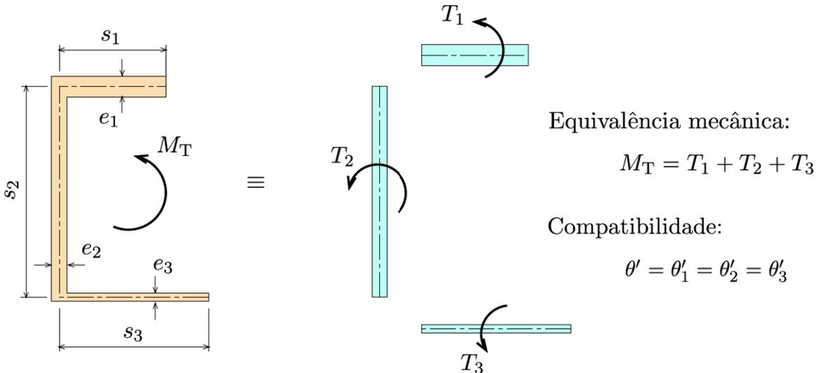
Fig. 13: Seção com várias espessuras.
