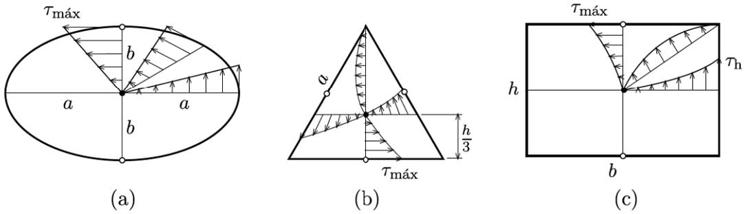
Fig. 5: Distribuição das tensões nas seções (a) elipsoidal, (b) triangular e (c) retangular.
