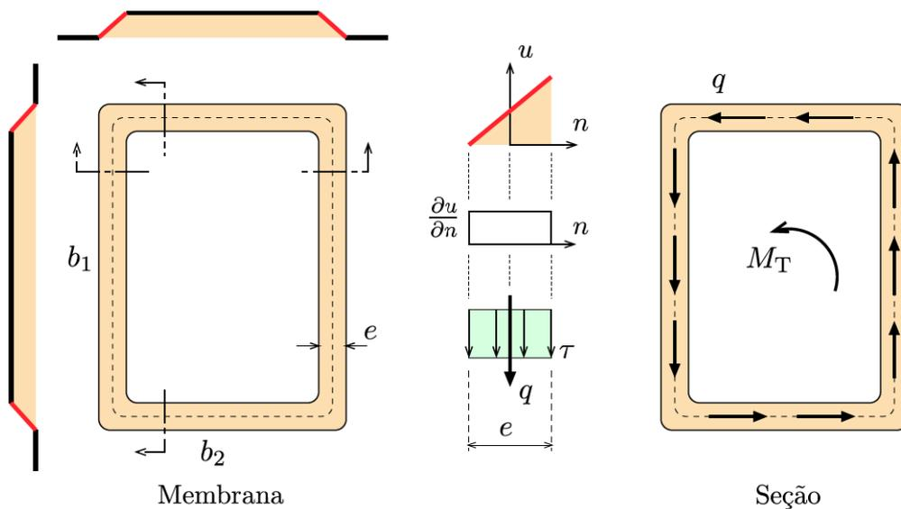
Fig. 11: Analogia de membrana para uma seção fechada.
