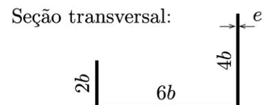
Fig. E1: Seção com espessura constante.
