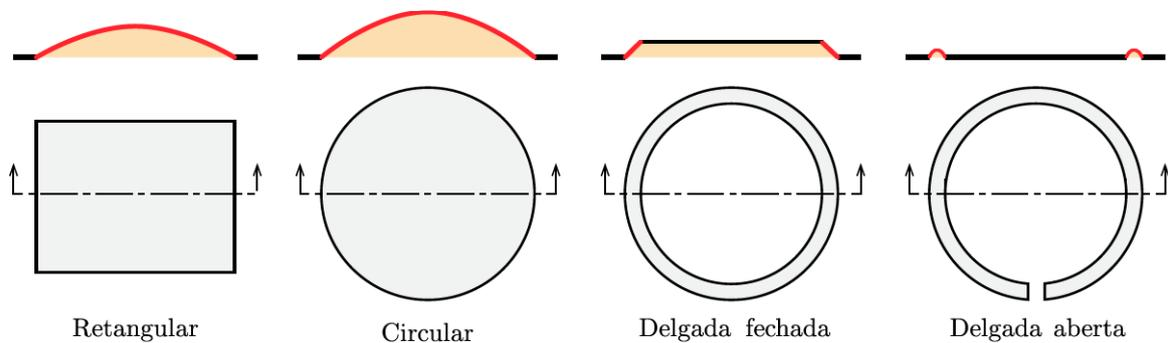
Fig. 9: Deformação das membranas para seções usuais.
