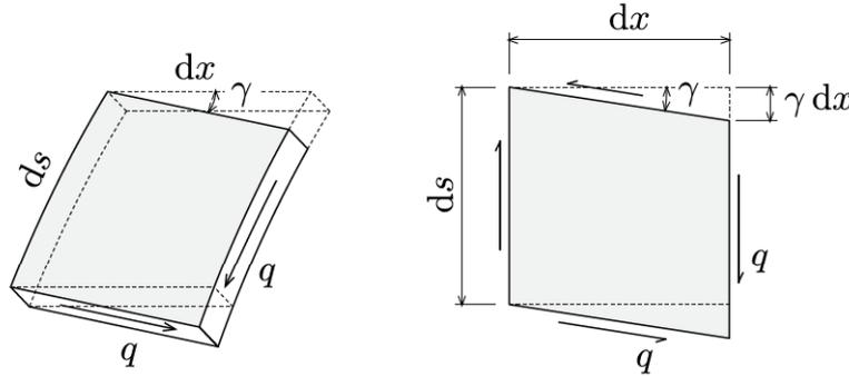
Fig. 17: Distorção de um elemento de parede infinitesimal.
