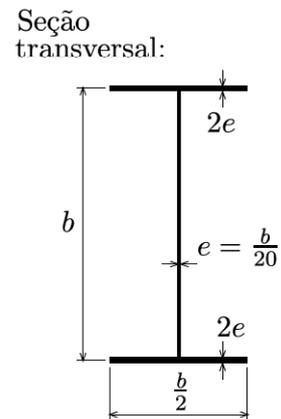
Fig. E2: Seção com duas espessuras.
