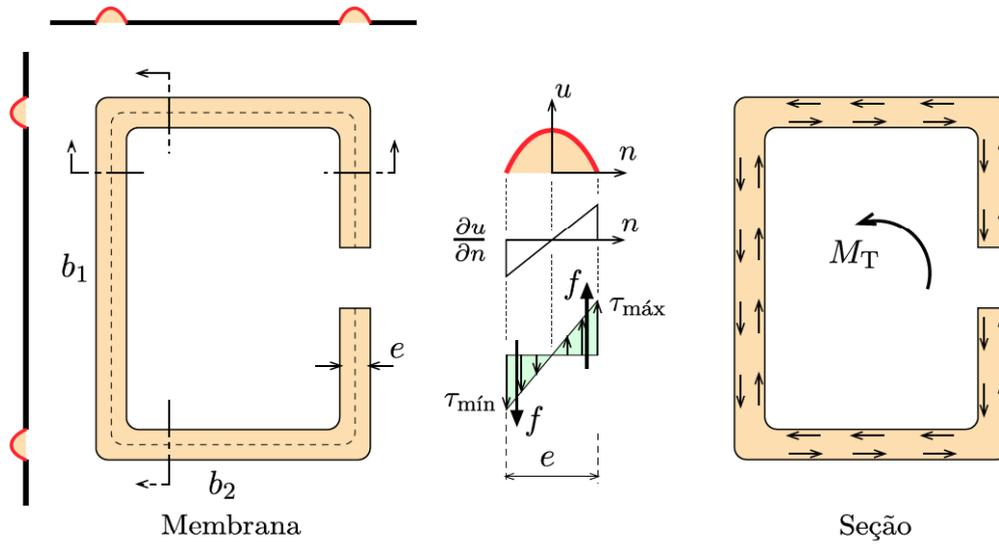
Fig. 10: Analogia de membrana para uma seção aberta.
