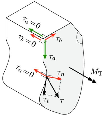
Fig. 6: Tensão tangencial junto ao contorno [Feodosiev (1980)].
