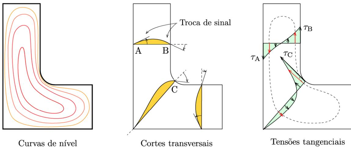
Fig. 8: Deformação da membrana e tensões tangenciais na ST.
