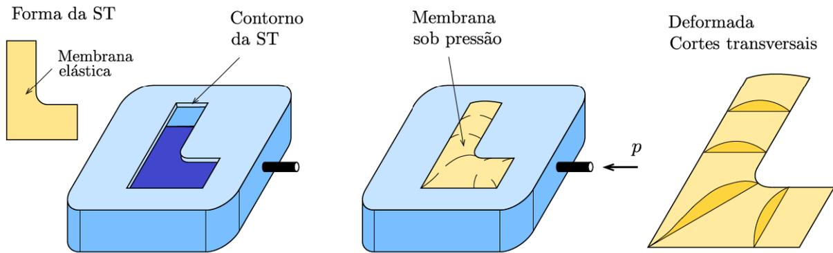
Fig. 7: Ensaio da analogia de membrana.
