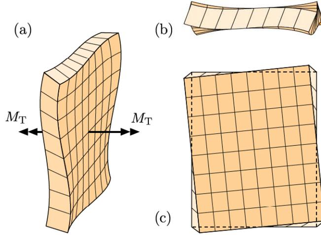
Fig. 4: Empenamento da ST retangular: (a) perspectiva; (b) vista superior; (c) vista frontal.
