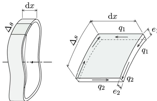
Fig. 15: Elemento da parede extraído de um trecho de barra.
