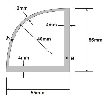
13) A parede da barra cuja seção tranversal é indicada na figura possui 1,5 mm de espessura. Sabendo que a tensão admissível de seu material é  $\bar{\tau}=2,5$  MPa, determinar o valor do máximo momento de torção que pode solicitar esta barra.
