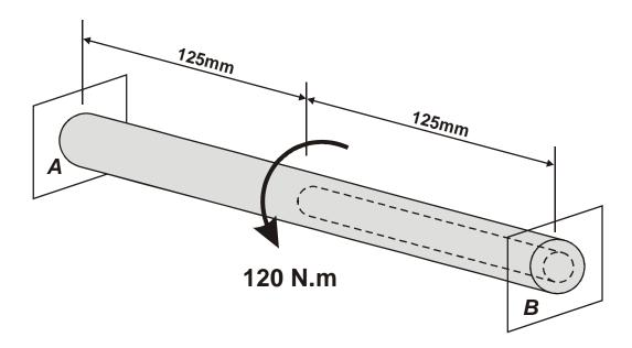
Resp: no trecho da esquerda, T = 75.5 Nm; no trecho da direita, T = -44.5 Nm.
