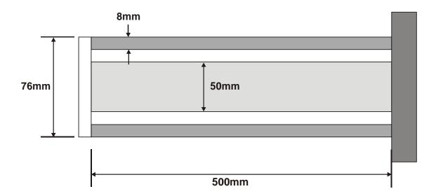
8) O eixo composto da figura, tem um núcleo de aço recoberto com um tubo de alumínio. Sabendo que a máxima tensão de cisalhamento no alumínio é  $\tau=60~MPa$ , determinar o valor da máxima tensão de cisalhamento no núcleo de aço. Tem-se G=80~GPa para o aço e G=27~GPa para o alumínio.
