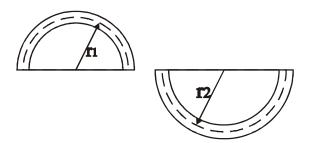
12) Determinar as tensões de cisalhamento nos pontos a e b da seção transversal indicada na figura, de um eixo solicitado por um momento de torção  $T=90\ Nm$ .
