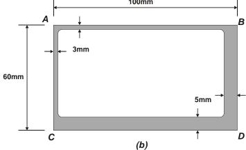
11) Determinar as tensões de cisalhamento nos pontos a e b da seção transversal indicada na figura, de um eixo solicitado por um momento de torção  $T = 90 \ Nm$ .
