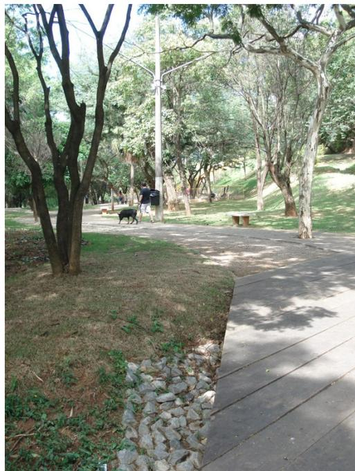
**Figura 21. Canal gramado (com trecho em pedras) sob travessia em madeira.**
