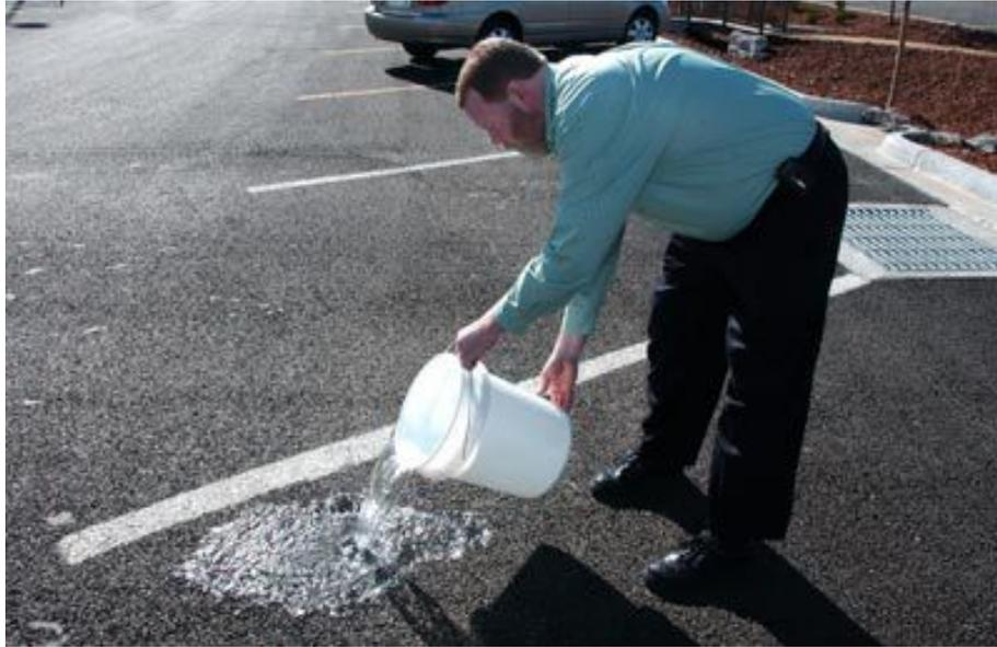
Figura 56. Concreto poroso asfáltico (CPA) mostrando sua propriedade drenante.
