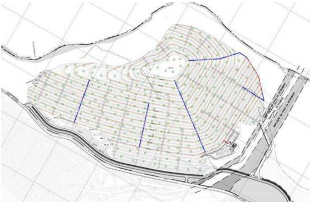
Figura A.2: Vista geral do sistema de captação e queima de biogás do Aterro CTL. (fonte: PDD (Documento de Concepção de Projeto) do Projeto de Biogás de Aterro CTL, extraído do website da Convenção Quadro das Nações Unidas sobre Mudanças Climáticas (UNFCCC). [38])
