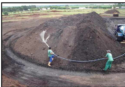
Figura 3.4: Aplicação de solução contendo microorganismos na leira de compostagem. Fonte: Organosolví.
