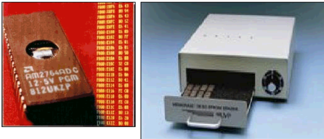
(a) EPROM, onde pode-se ver a janela para irradiação ultravioleta. (b) Apagador de EPROM.
