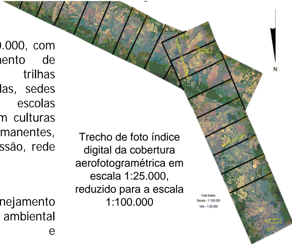
Trecho de foto índice digital da cobertura aerofotogramétrica em escala 1:25.000, reduzido para a escala 1:100.000
