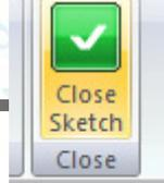
Clique em **Close Sketch**. Se movimentar o cursor do mouse, notará que a extrusão irá para um lado ou outro do plano de referência frontal. No campo **Final Extend** em **Distance**, digite o valor **70** e tecele **Enter**. Arraste o cursor do mouse para o lado esquerdo do plano e clique com o botão esquerdo do mouse. Clique em **Finish**.
