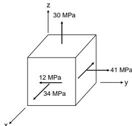
O cubo elementar da figura representa o estado de tensões em um ponto  $P$  de uma estrutura. A tensão de escoamento do material dessa estrutura é de 150MPa em tração e de 50MPa em cisalhamento. Seu limite de resistência à compressão é de 100MPa. Pede-se:
