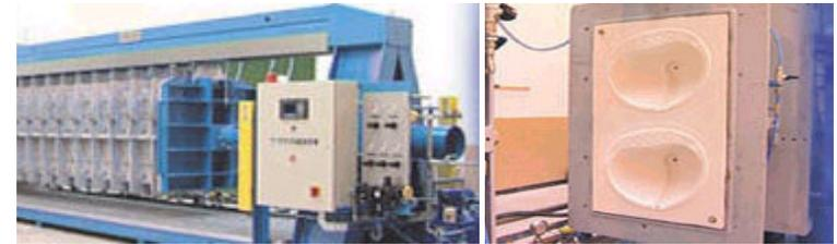
FIGURA 9 – Sistema de colagem sob pressão usado na fabricação de peças sanitárias.
