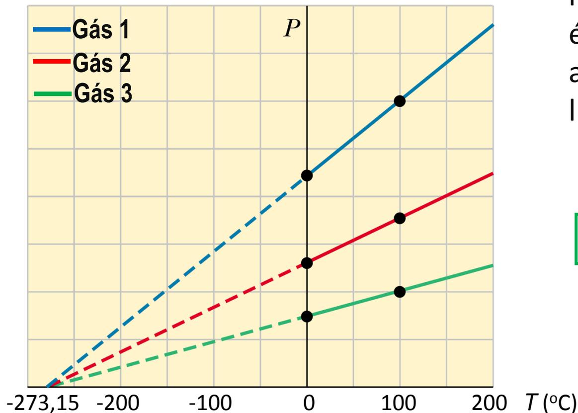
é utilizada como base para a definição da escala absoluta de temperatura
