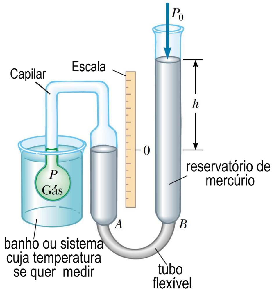
Este aparato mede a pressão do gás contido no recipiente imerso em um banho. O volume do gás (p.e. hidrogênio) no recipiente e no capilar é mantido constante através do aumento ou diminuição do nível de mercúrio no reservatório  $B$ , para manter constante o nível de mercúrio na coluna  $A$ . A pressão  $P$  do gás no recipiente, é dada pela expressão:
