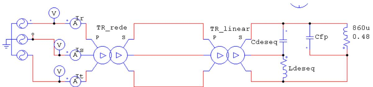
Figura 6 Inclusão da Impedância de rede à carga compensada
