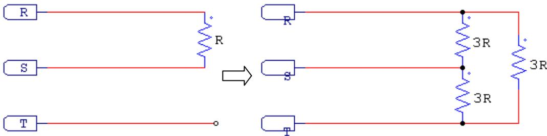
Figura 4 Carga monofásica resistiva, e circuito equivalente desta carga após a compensação de desequilíbrio
