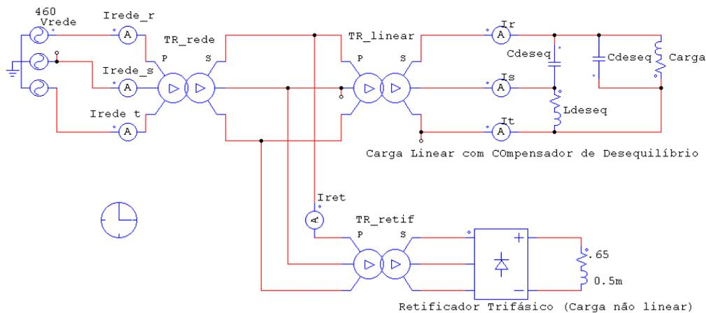
Figura 7 Sistema elétrico com ocorrência de ressonância
