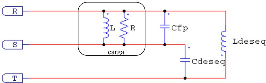
Figura 3 Circuito de compensação de desequilíbrio p/ a carga monofásica linear
