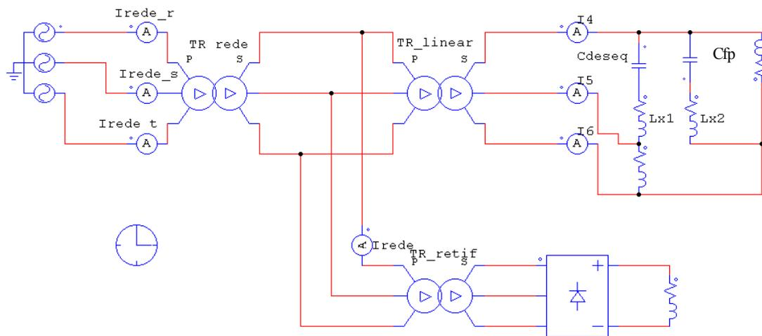
Figura 8 Solução de problema de ressonância pela inserção de indutores ( $L_{x1}$  e  $L_{x2}$ )
