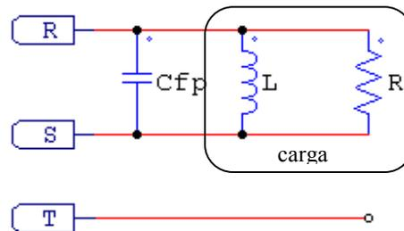
Figura 2 Compensação de fator de potência de carga linear
