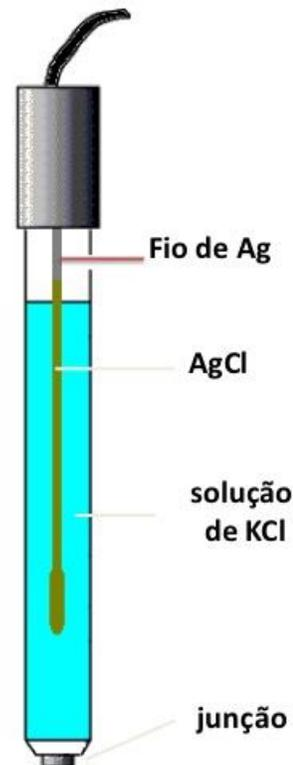
É um eletrodo muito usado como eletrodo de referência. Consiste em um fio de prata recoberto com cloreto de prata em contato com uma solução de cloreto de potássio saturada.
