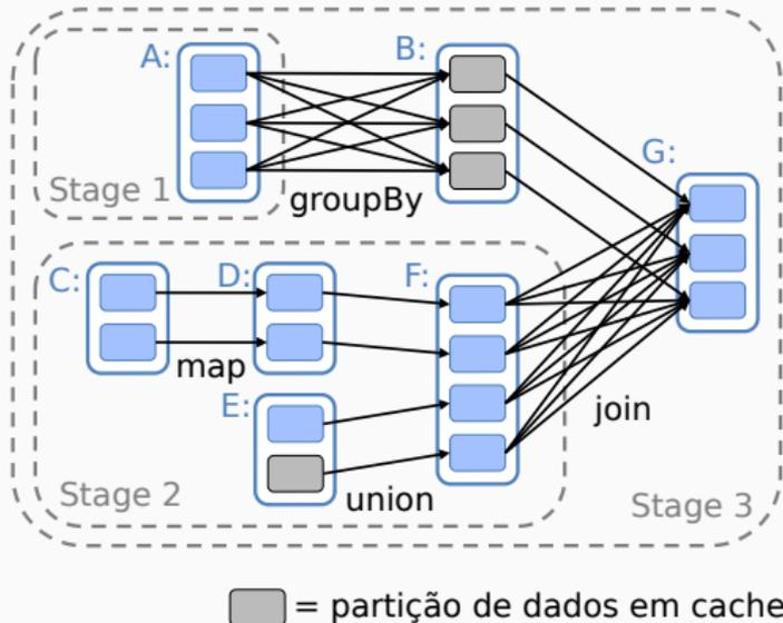
**Figura:** Para executar uma ação no RDD G, o Spark calcula as dependências e escalona a execução das transformações em cada estágio. Nesse caso, o RDD de saída do estágio 1 já está na memória, então o Spark executa o estágio 2 e depois o 3.
