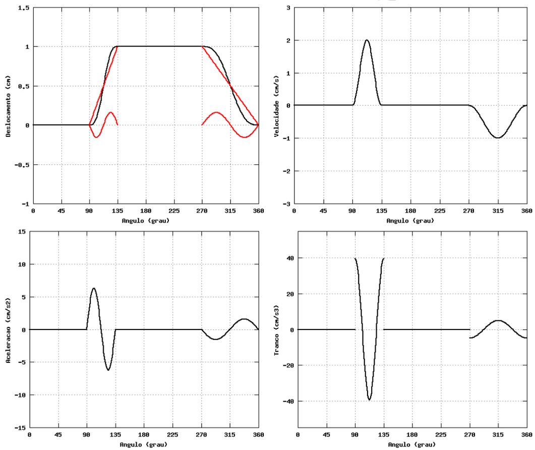
Figura 6: Diagramas com as curvas obtidas no projeto usando cicloide.
