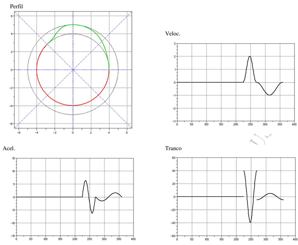
Figura 9: Resultados para cicloide em subida descida.
