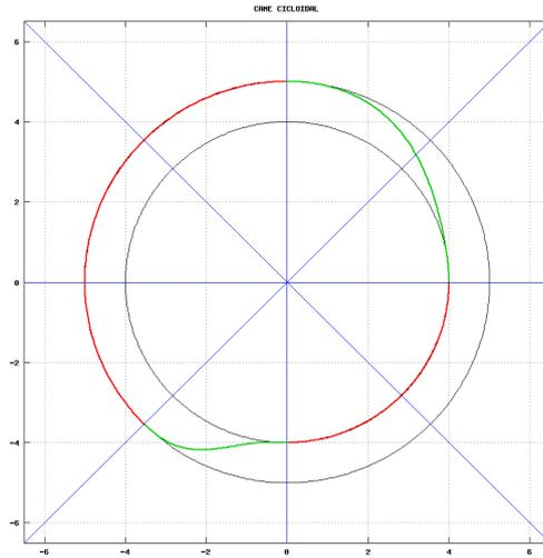
Figura 5: Perfil do came obtido no projeto usando cicloide.
