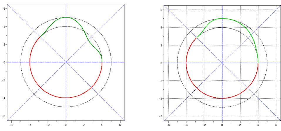
Figura 10: Resultados para polinômio em subida descida. Esquerda, uso de um único polinômio para subida-descida. Direita, uso de polinômios distintos para subida e para descida.
