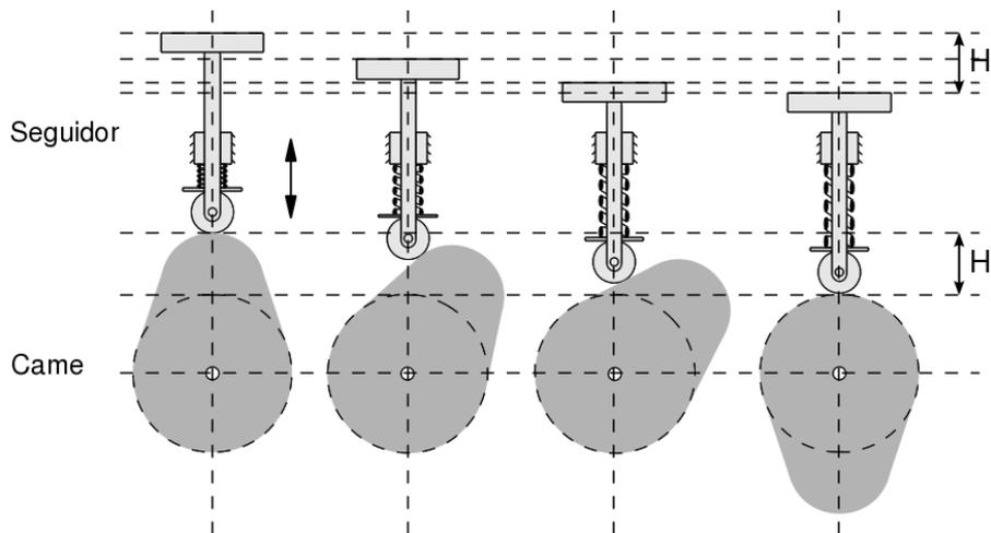
Figura 1: Meio ciclo de movimentação (descida) de um came com seguidor tipo rolete.
