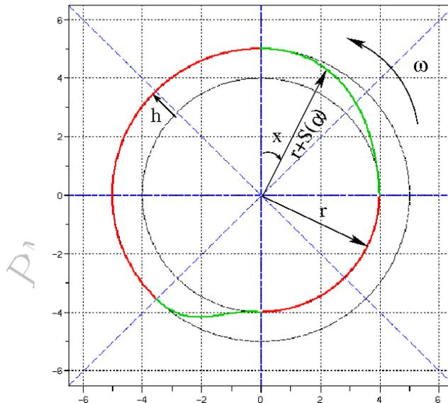
Figura 11: Esquema do came do exemplo.
