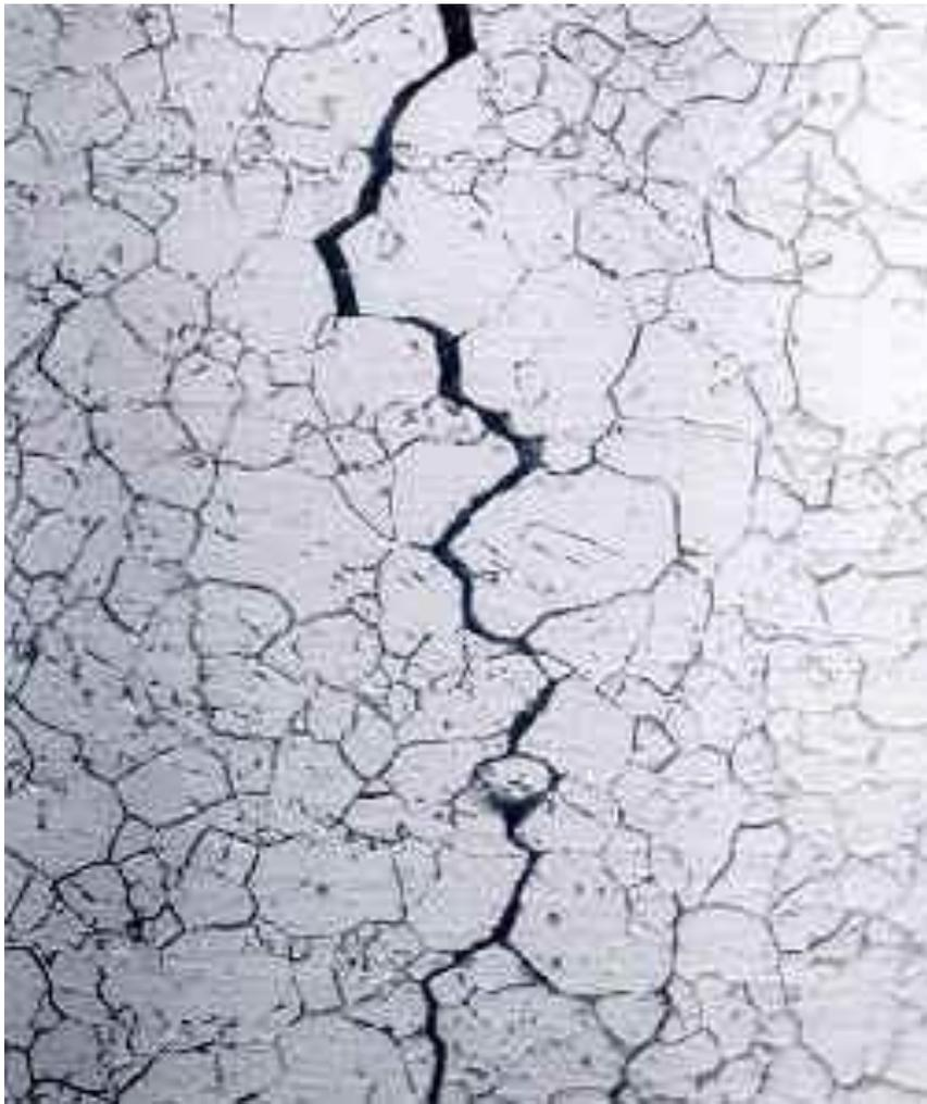
**CST intergranular de uma tubulação de liga 600 em água de serviço ácida contendo H<sub>2</sub>S**
