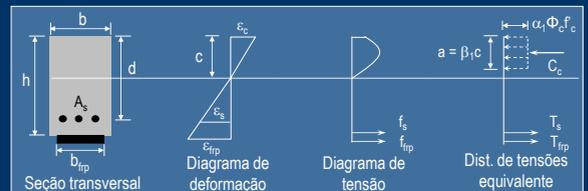
**Passo 7:** Determinar a profundidade do eixo neutro
