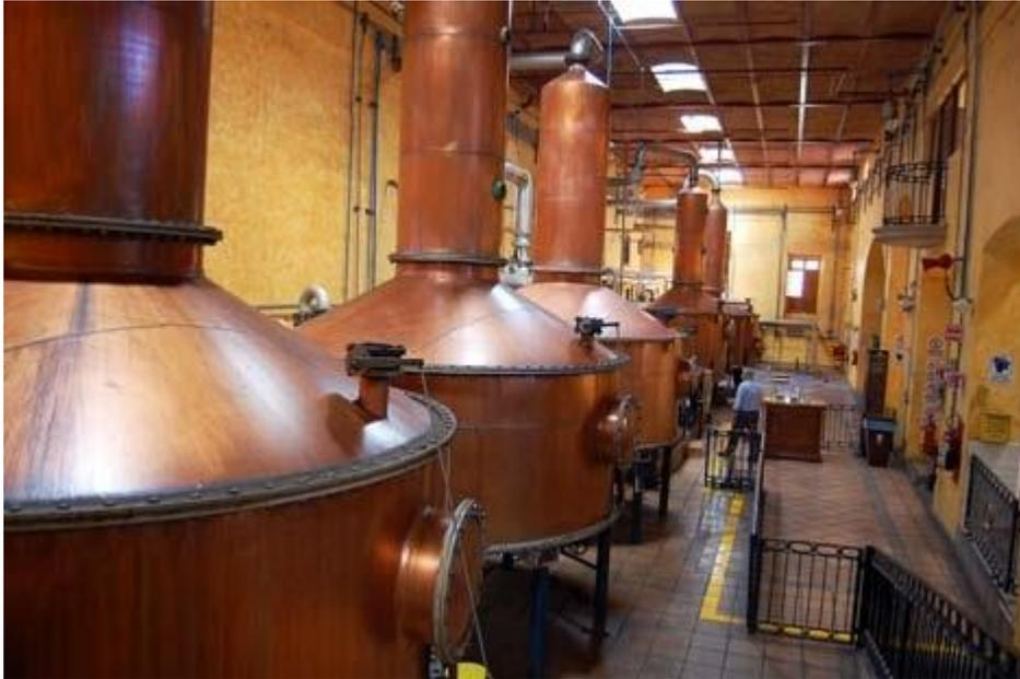
Os processos de destilação podem ser realizados por batelada, mediante o uso de alambique, ou de maneira contínua, mediante o uso de colunas de destilação. Os dois tipos de equipamento podem ser de cobre ou aço inoxidável.
