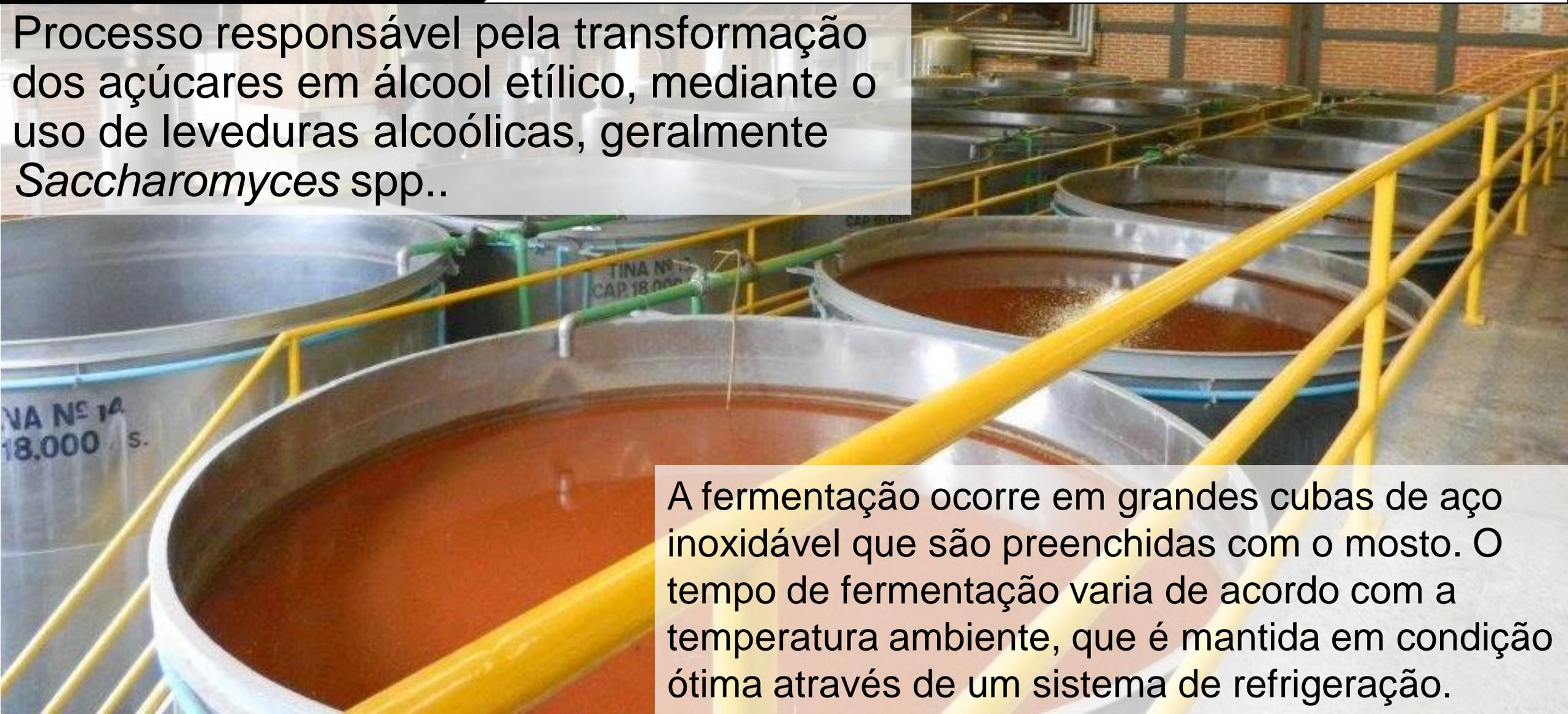
A fermentação ocorre em grandes cubas de aço inoxidável que são preenchidas com o mosto. O tempo de fermentação varia de acordo com a temperatura ambiente, que é mantida em condição ótima através de um sistema de refrigeração.
