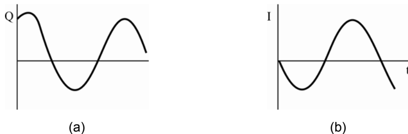
Figura 0.3 - Comportamento típico de Q(t) e I(t) em um circuito LC
