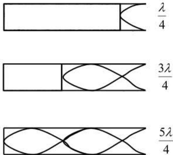
Figura 1 – Representação de ondas estacionárias em um tubo de acrílico para diferentes relações de distância da coluna de ar e comprimento de onda. As ondas indicam o deslocamento das moléculas de ar.
