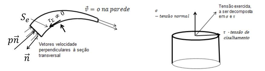
Trajetórias retilíneas e paralelas nas entradas e saídas  $\rightarrow$  as tensões nas superfícies  $\sum S_e \ e \ \sum S_s$  se reduzem apenas às tensões normais devidas às forças de pressão. Isto ocorre quando se considera a distribuição de velocidades uniforme, o que ocorre aproximadamente nos escoamentos turbulentos:
