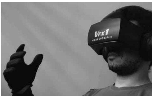
Figura 1 – Capacete de realidade virtual (Head Mounted Display).
