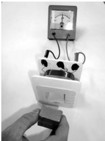
Figura 0.17 - Galvanômetro conectado à bobina, com um ímã se aproximando desta
