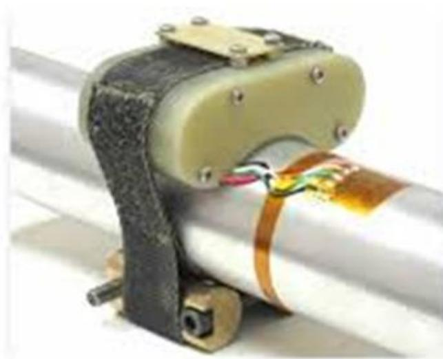
Medição de torque por Telemetria, com o uso de Extensômetro
