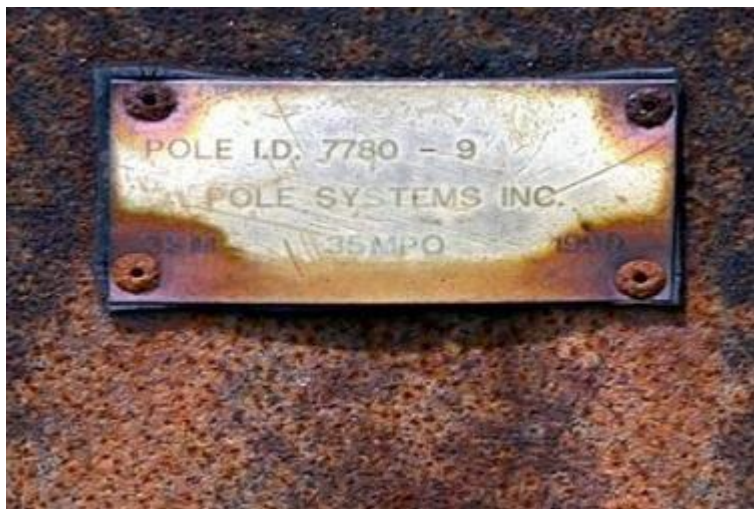
Corrosão Galvânica entre aço (parafuso) e placa de latão
