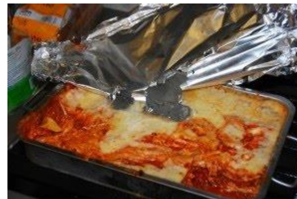
Assadeira de aço e folha de Al para cobertura – corrosão desta última nos pontos onde toca o alimento.
