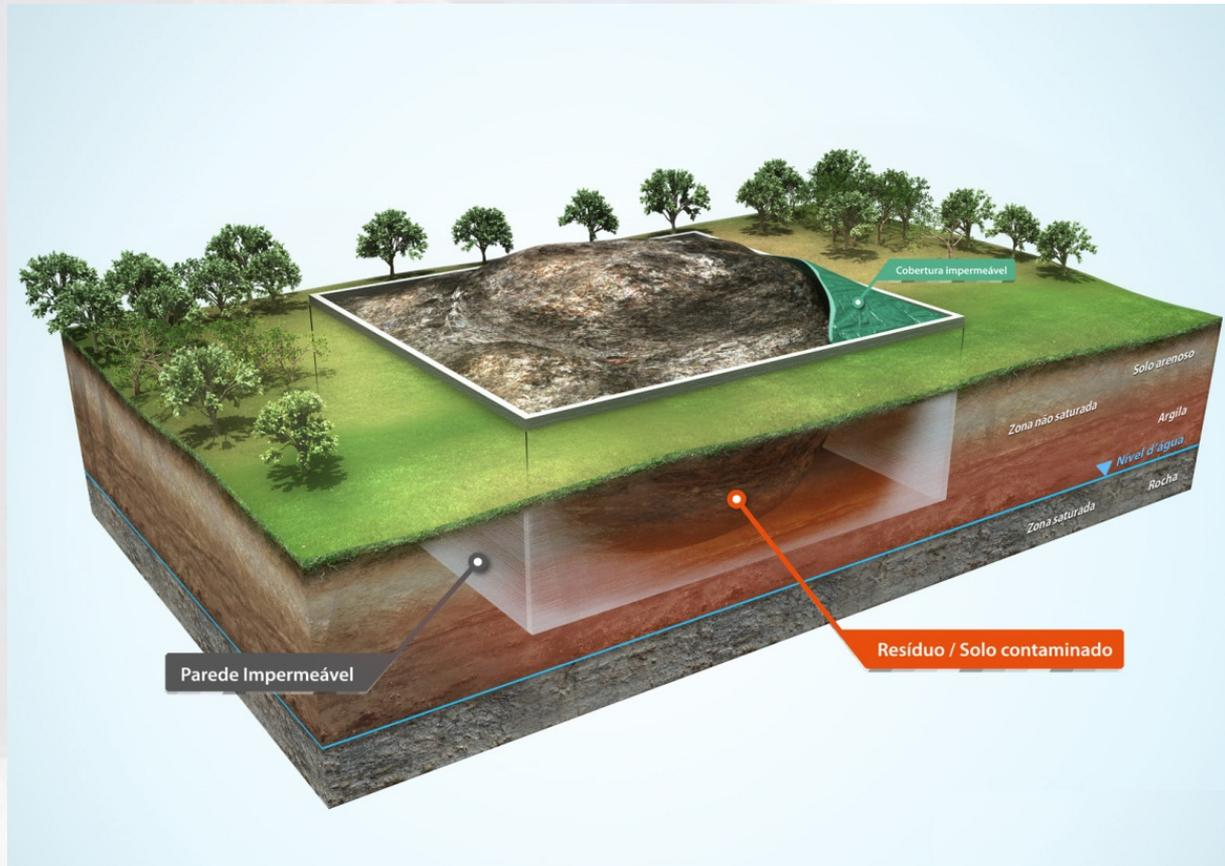
Trata-se do confinamento de uma área utilizando barreiras de baixa permeabilidade com o objetivo de isolar a área contaminada in situ.
