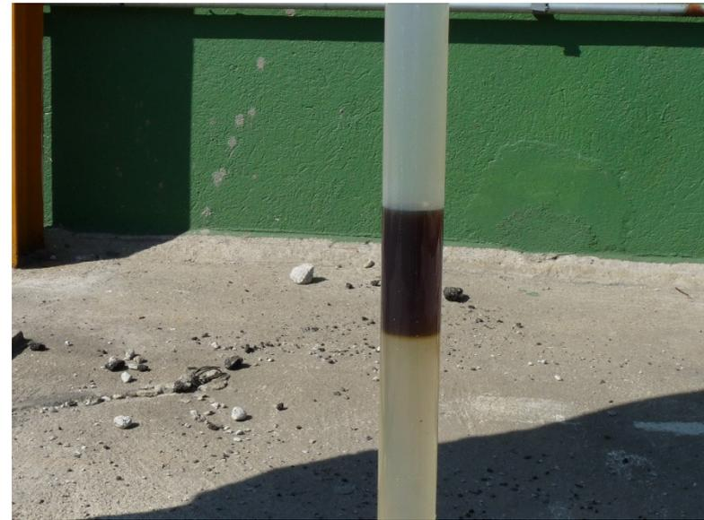
**LNAPL - *Light Non-Aqueous Phase Liquid*** (líquido não aquoso menos denso que a água) – Densidade  $< 1$
