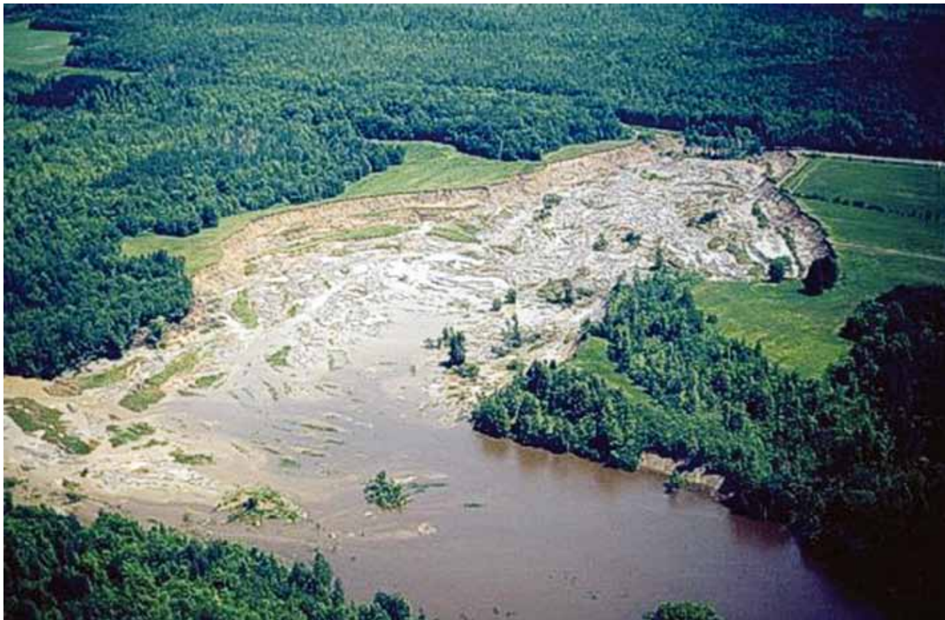
Figura 20. Fluxo de terra de Lemieux, 1993 — um rápido fluxo de terra ocorrido em argila marinha sensível, próximo a Ottawa, Canadá. O cume da escarpa regrediu 680 metros no nível do solo, passando por cima da margem do rio. Aproximadamente 2,8 milhões de toneladas de argila e silte liquifizeram e escorreram para o vale do rio South Nation, represando o rio. (Imagem de G. R. Brooks do Geological Survey of Canada).
