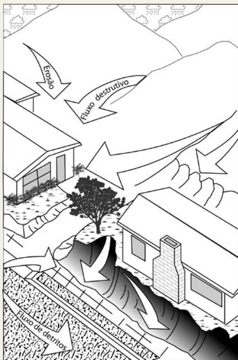
Figura C38. Esquema de uma casa desprotegida, no caminho de um fluxo de detritos e (ou) deslizamento de lama. Métodos sugeridos para reduzir os riscos de fluxos de detritos são mostrados na Figura C39.
