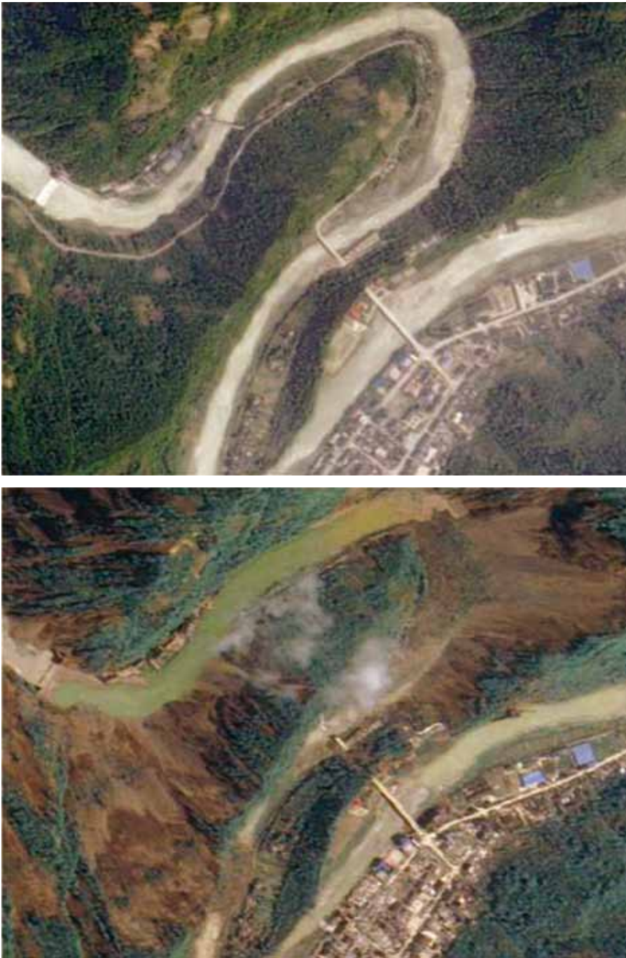
Figura 43. O grande terremoto que atingiu a China em 12 de maio de 2008 causou muitos danos ao terreno montanhoso do distrito de Beichuan. Em muitos casos, os deslizamentos de terra em vales íngremes formaram barragens, criando novos lagos, em um período de horas. Este par de fotos de alta resolução, com imagens do satélite Formosat-2 de Taiwan, em 14 de maio de 2006 (topo) e 14 de maio de 2008 (abaixo), antes e depois do terremoto, mostram o grande deslizamento que bloqueou o rio Jiangjian, formando um perigoso lago represado.
