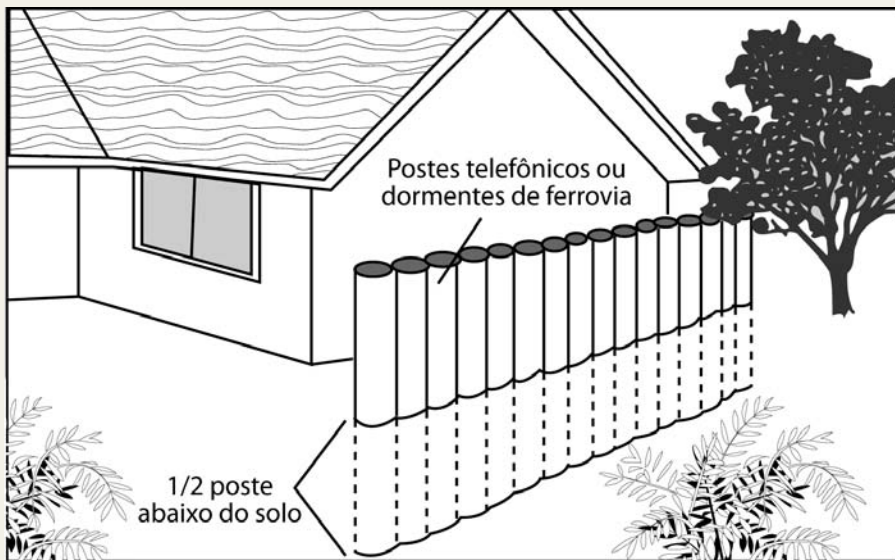
Figura C51. Uma alternativa aos defletores de madeira - pedaços de postes de telefone ou dormentes de ferrovias.
