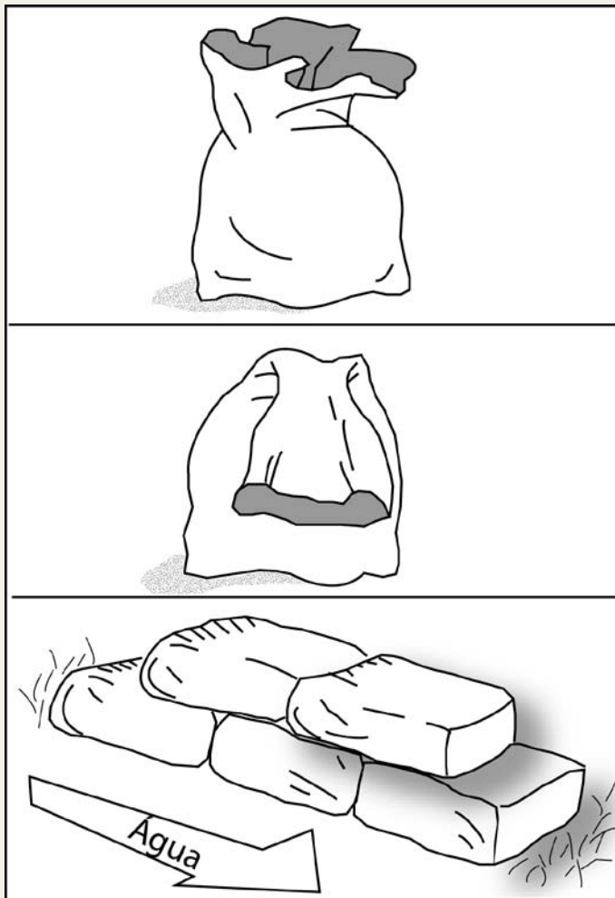
Figura C41. Sacos de areia são basicamente para proteção contra pequenos fluxos, de 0 até 0,6 metros (2 pés). Proteção para maiores fluxos requer um tipo mais permanente da estrutura. Note-se que sacos de areia não irão isolar a água.
