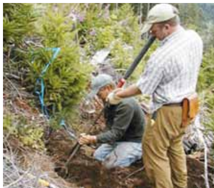
Figura B8. Medição de movimento de deslizamento utilizando um extensômetro, instrumento que pode detectar o movimento da superfície do solo entre o solo estável e solo em deslizamento. (Fotografia por Richard LaHusen, U.S. Geological Survey.)
