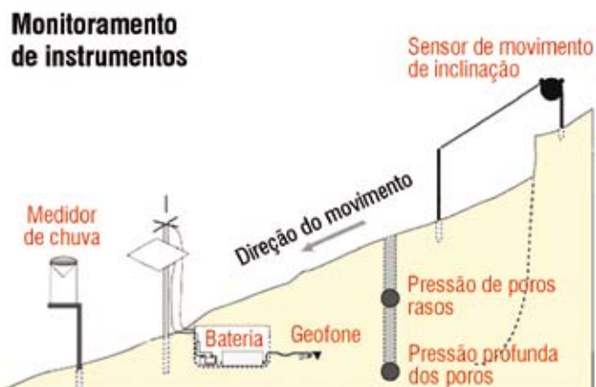
Figura B10. Exemplo de uma rede para medição e transmissão em tempo real de dados do deslizamento. (Modelo esquemático da U.S. Geological Survey.)
