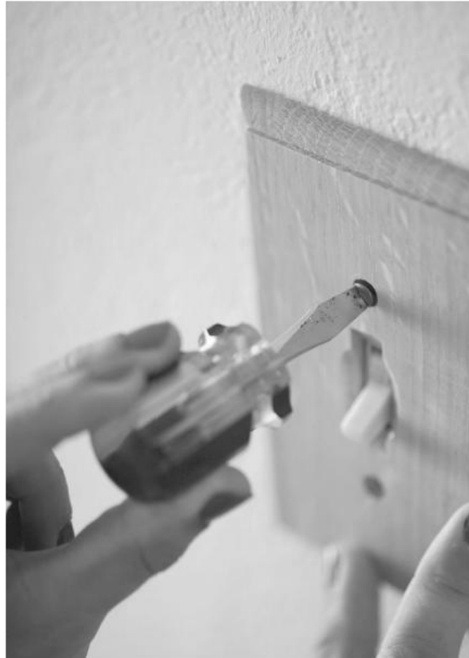
Figura 10.7 Para afrouxar ou apertar um parafuso é necessário fornecer a ele uma aceleração angular e, portanto, aplicar um torque. Essa tarefa é facilitada usando-se uma chave de fenda com um punho com raio grande, para que o braço da alavanca da força que você aplica com a sua mão seja maior.
