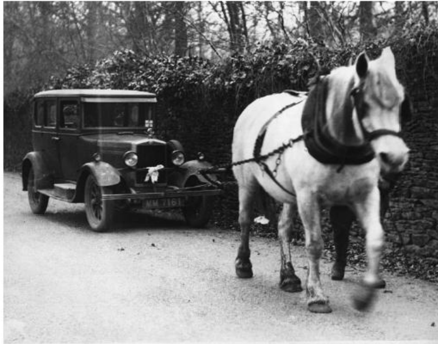
Figura 6.26 O valor do horsepower deriva de experiências conduzidas por James Watt, que mediu que um cavalo poderia produzir 33000 pés-libra de trabalho por minuto ao içar carvão de uma mina.
