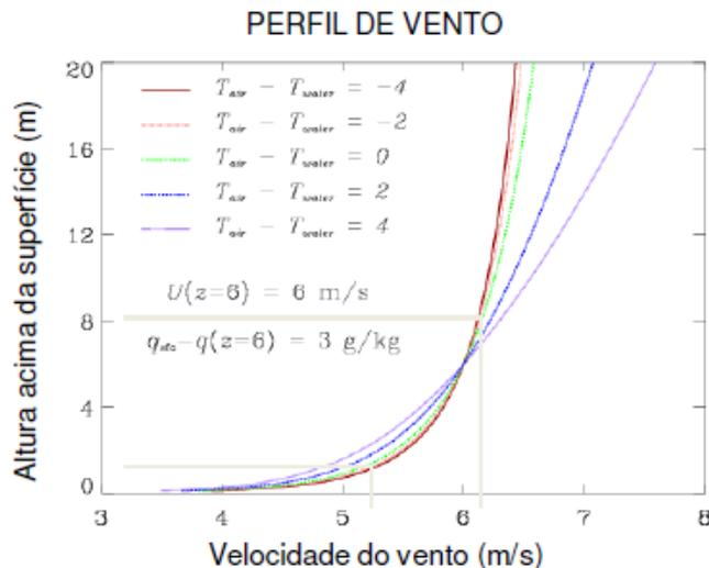
A velocidade do vento aumenta exponencialmente com a altura. Isso se dá em função da redução do atrito conforme o fluxo de ar se distancia da superfície. Assim, a velocidade do vento a 10m de altura (p/ fins meteorológicos) será maior do que aquela medida a 2m (p/ fins agrônômicos)
