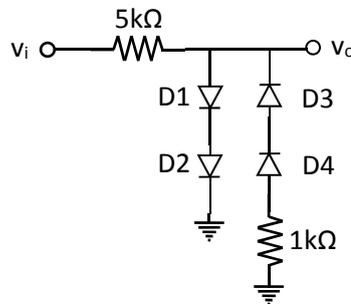
**Exercício 7** – O circuito grampeador abaixo é acionado em sua entrada por uma onda quadrada de amplitudes  $\pm 10V$ , esboce a forma de onda na saída  $v_o$ .
