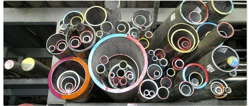
**Aço** é uma liga metálica formada essencialmente por ferro e carbono, com percentagens deste último variando entre 0,008 e 2,1%. Distingue-se do ferro fundido, que também é uma liga de ferro e carbono, mas com teor de carbono entre 2,1% e 6,7%.
