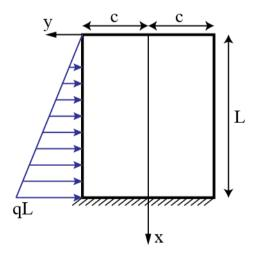
Este modelo pode ser usado para a modelagem de uma barragem prismática de seção retangular. Supondo-se que se deseja utilizar a formulação do problema em termos de função de tensão de Airy para se obter uma solução próxima da solução do modelo mostrado na figura.
