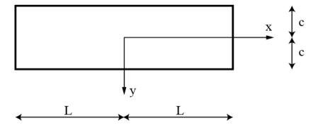
c) Considerando o problema dado pela figura abaixo, determinar as constantes a, b e d tal que a superposição das soluções geradas pelas funções de tensão  $\Omega_1$ ,  $\Omega_2$  e  $\Omega_3$  satisfaça as condições de contorno para as bordas y = c e y = -c.
