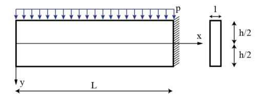
Com o intuito de se obter uma solução aproximada para o modelo descrito acima, utiliza-se a seguinte função de tensão de Airy:
