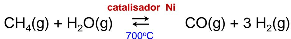
O vapor d'água é usado para reagir com cerca de 45% do metano (CH<sub>4</sub>); o restante [reage com ar](#):
