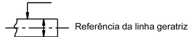
O elemento de referência deve ser suficientemente exato e, quando necessário, indicar-se também uma tolerância de forma.
