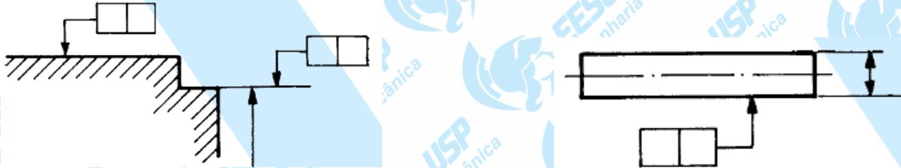
Toca a linha de extensão em prolongamento a linha de cota, quando tolerância for aplicada ao eixo ou ao plano médio do elemento cotado.
