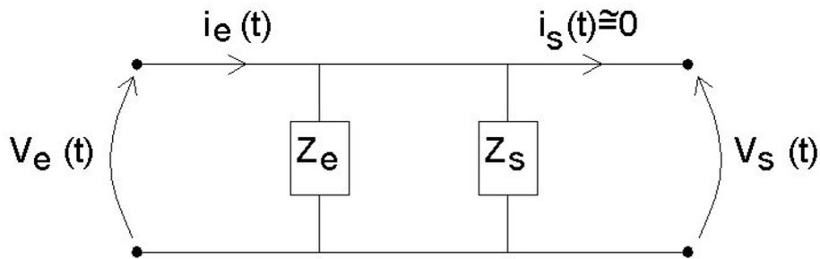
**Figura 1.18: Modelo simples para um quadripolo elétrico**
