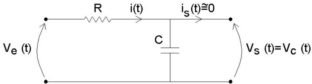
**Figura 1.19: Modelo de um quadripolo RC**
