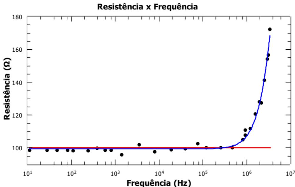
$$Z_0 = \sqrt{R^2 + \omega^2 L^2} \Rightarrow R = 99,4 \pm 0,5 \Omega \quad \text{e} \quad L = 40,0 \pm 0,5 \mu\text{H}$$
