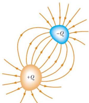
**Capacitor:** Combinação de dois condutores carregados com mesma carga mas sinais opostos. Os condutores são denominados placas e uma diferença de potencial existe entre devido a presença das cargas.
