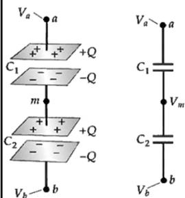
Os pontos  $a$  e  $b$  estão conectados a uma bateria que mantém a diferença de potencial  $V = V_a - V_b$ , contante através dos capacitores. Se uma carga  $+Q$  é colocada na placa superior do primeiro capacitor, o campo elétrico induzirá uma carga  $-Q$  na placa inferior deste. Esta carga virá dos elétrons tirados da placa superior do segundo capacitor, induzindo cargas  $+Q$  e  $-Q$  nas placas deste. neste:
