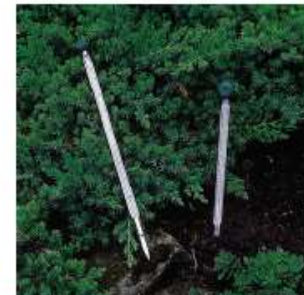
Sensor automático para medida da temp. do solo
