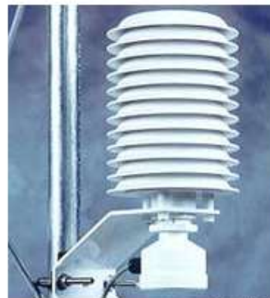
Abrigo meteorológico utilizado em estações meteorológicas automáticas
