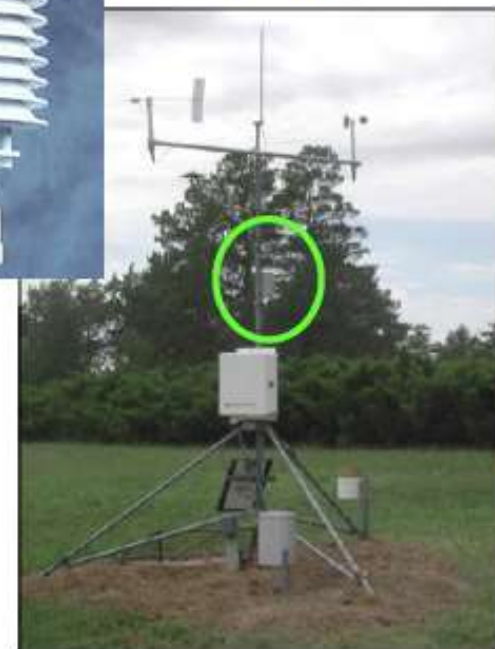
Abrigo meteorológico utilizado em estações meteorológicas automáticas
