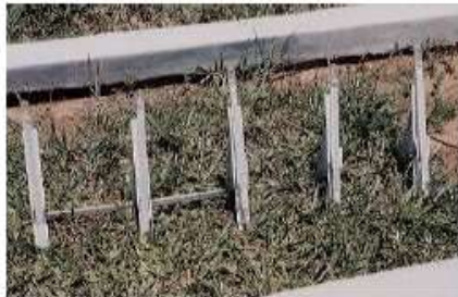
Geotermômetros instalados em gramado
