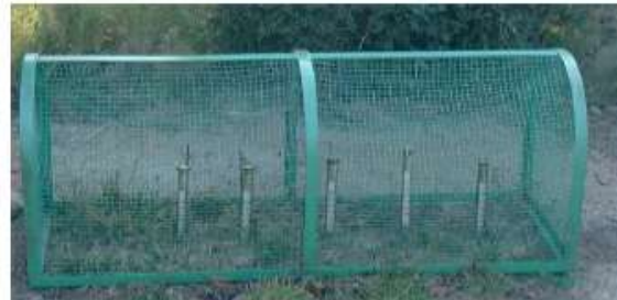
Geotermômetros instalados em solo desnudo
