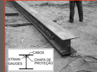
Vista das chapas de proteção dos strain gauges e cabos-obra nº 8
