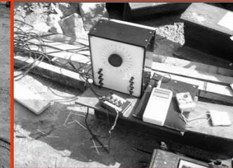
Caixa seletora e painel digital para leitura dos strain gauges-obra nº 8.
