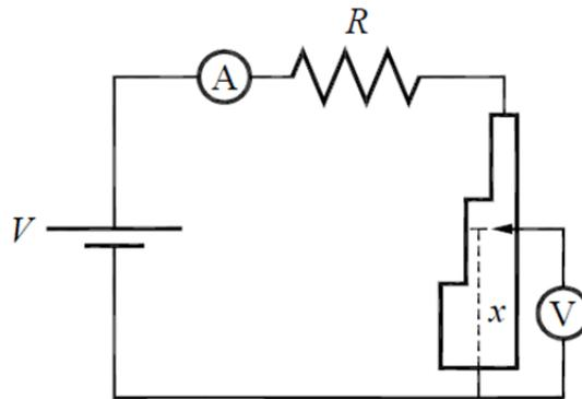
3. Faça um gráfico da tensão em função do comprimento  $x$ , destacando as 3 regiões. Qual o comportamento observado em cada região? Explique o comportamento observado com base nas áreas transversais da fita metálica.
