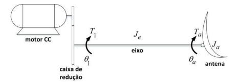
onde  $J_a$  e  $J_e$  são os momentos de inércia da antena e do eixo, respectivamente;  $T_1$  e  $T_a$  são os torques aplicados na saída da caixa de redução e na antena, respectivamente; e  $\theta_1$  e  $\theta_a$  são os deslocamentos angulares do eixo, na saída da caixa de redução, e da antena, respectivamente.
