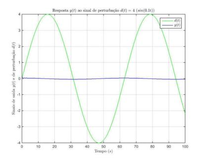
a saída apresenta uma variação máxima de amplitude  $\approx |0,04|,$  como pode ser visto na visão ampliada da figura acima:
