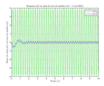
a saída apresenta uma variação máxima de amplitude  $\approx |0.135|,$  como pode ser visto na visão ampliada da figura acima:
